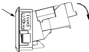
2. モジュールの凹み部分をアダプタの凸部分に合わせ、モジュールを図のように押し下げます。
