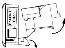
1. タブを押し下げ図のようにモジュールを押し上げます。
