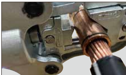
胴体部にプリントされている黒線の中央部を圧着。 (BMS3-325/200は2回の圧着)
