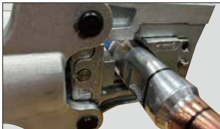
胴体部にプリントされている黒線間中央部を圧着。
