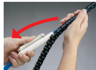
4) パンラップと束線をしっかり掴んで、工具を束線に沿って引っ張る
