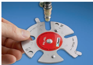
① エアープラにフィッティングを取り付ける
