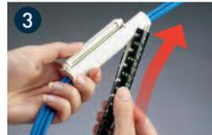
3 パンラップを専用工具に取り付け、先端が束線を8cmほどカバーするまで差し込む
