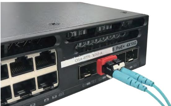
未使用のSFPポートを保護します。また、未接続のLCコネクタも併せて保護します
