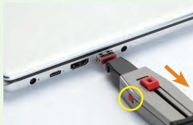
レバーを最前面まで押し出してブレードキーを露出させます。上下の向きに注意してブレードキーをポートブロックに差し込みます。レバーを少し戻して、そのままポートブロックを引き抜きます。
