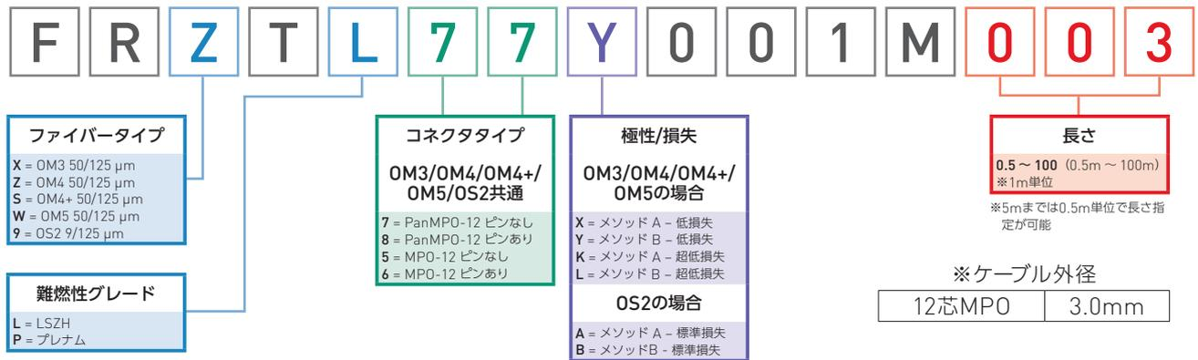
上記の部品番号 **FRZTL77Y001M003**：インターコネクケーブル、OM4 50/125μm、12芯、LSZH、両端ともPanMPO-12ピンなしコネクタ、メソッドB - 低損失、長さ3m
