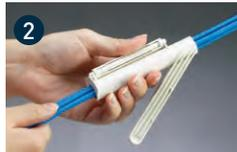
2 パンラップ専用工具を閉じて束線を挟み込む
