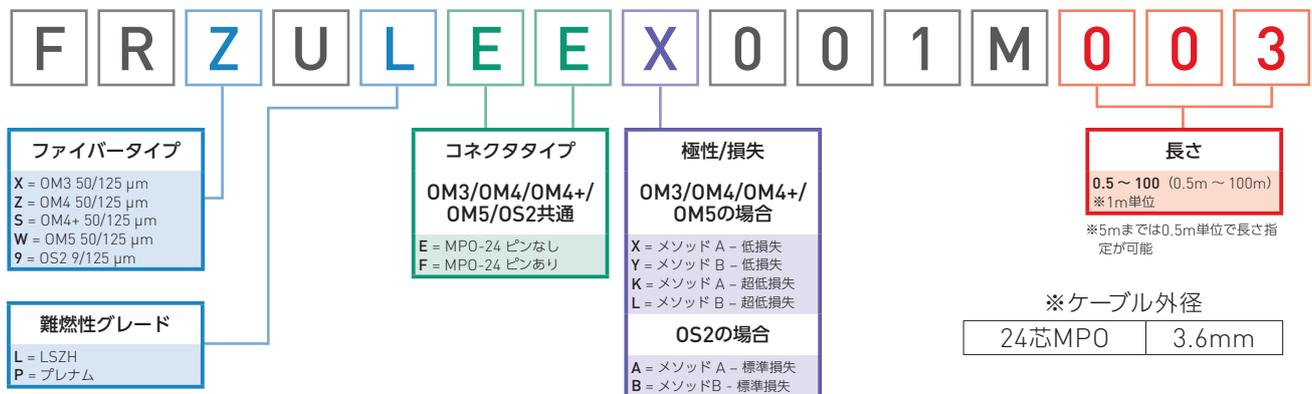
上記の部品番号 **FRZULEEX001M003**：インターコネクケーブル、OM4 50/125μm、24芯、LSZH、両端ともMPO-24ピンなしコネクタ、メソッドA - 低損失、長さ3m
