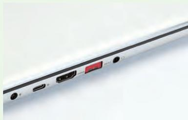
USB Type-A用 ポートブロックを挿入します。
