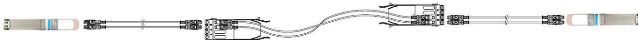
図はリンクの「上面図」です。MPO は 800G デュアル MPO トランシーバに垂直に取り付けられます
